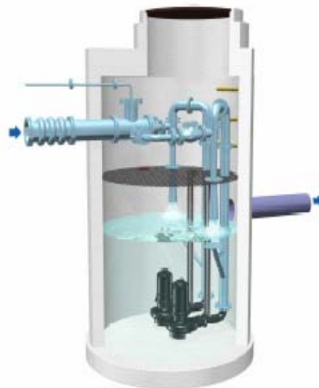
図1 道路埋設型真空ステーション
