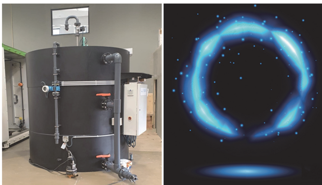
図1 te-ion 本体（左側）、非熱的プラズマによるグロー放電発生の様子（右側）
