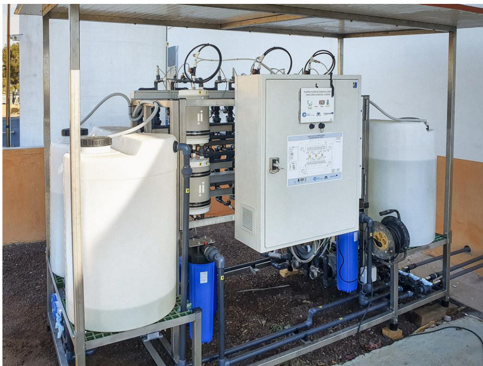
図1 2本の膜を直列に並べ三段の並列なラインに設置された中空糸のF0膜
