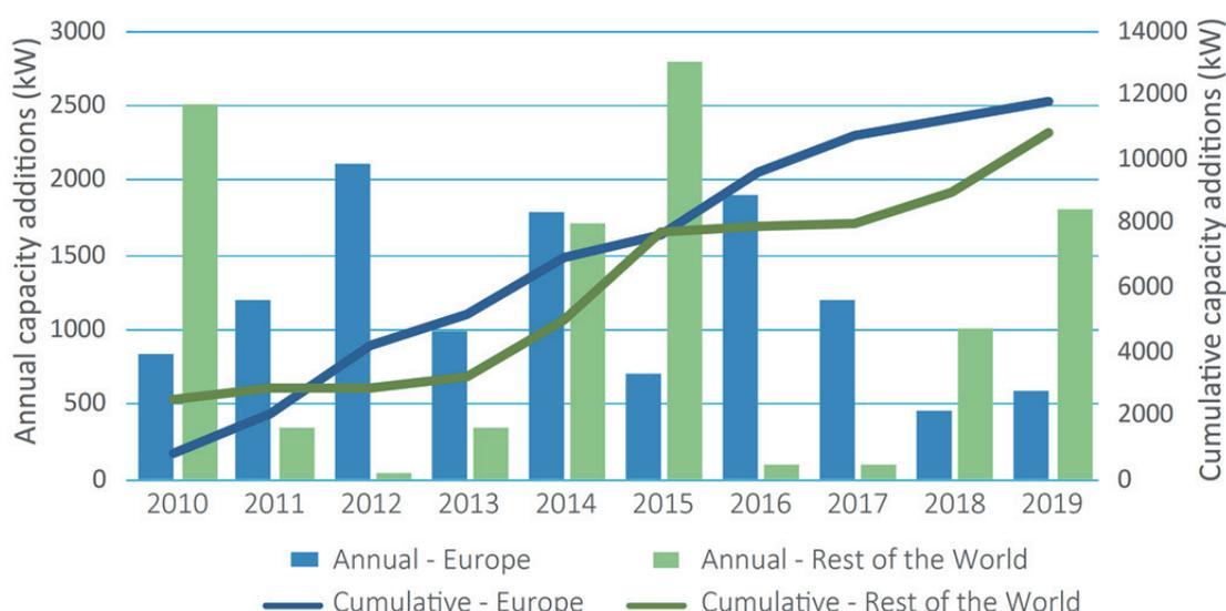
図7 欧州とその他の地域における波力設備の年間設置容量と累計設置容量の推移比較
