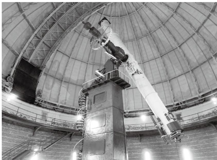
シカゴ大学のヤーキス天文台にある世界最大の光学の屈折型望遠鏡
