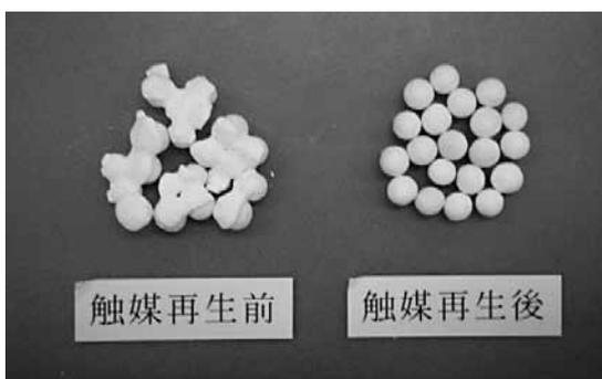
写真1 触媒再生前後の触媒外観
