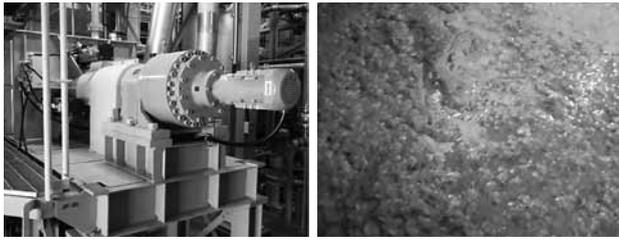
写真1 スクリュープレス型脱水機 写真2 脱水補助剤(解織古紙)
