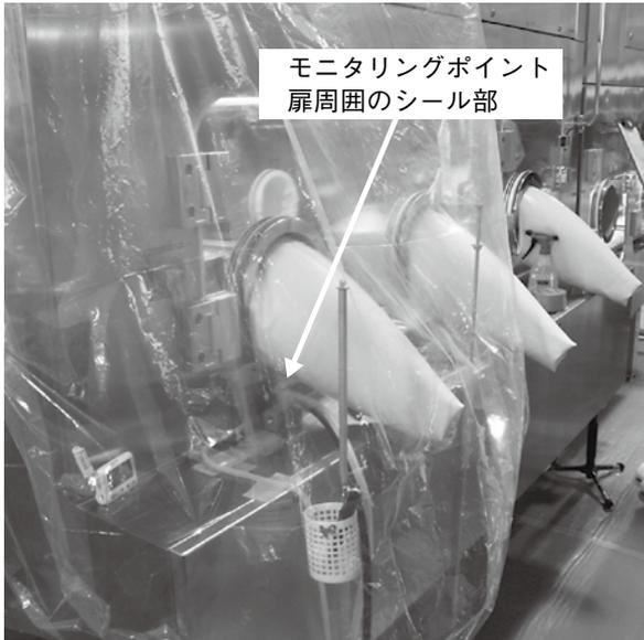
写真2 無菌製剤用アイソレータを使用した検証実験の様子
