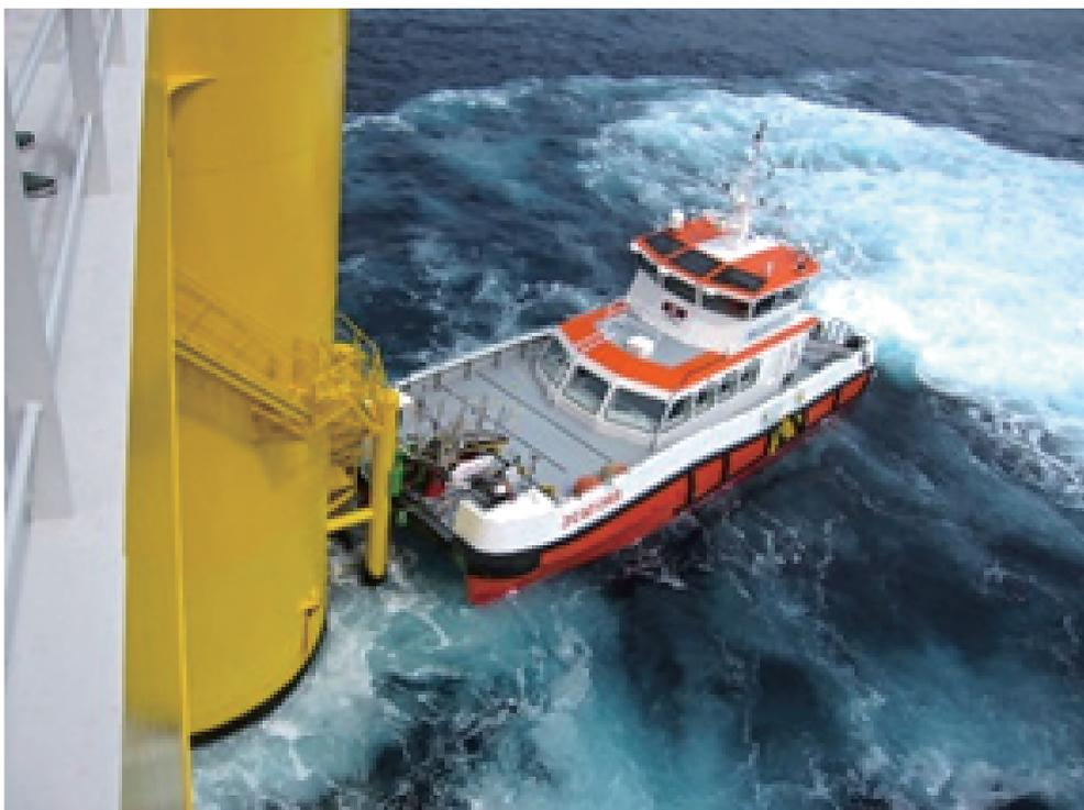
写真1 CTVによる接舷状況例<sup>1)</sup>
