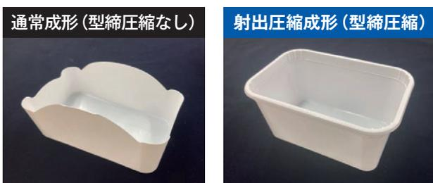
写真5 通常成形と射出圧縮成形の充填性の比較
