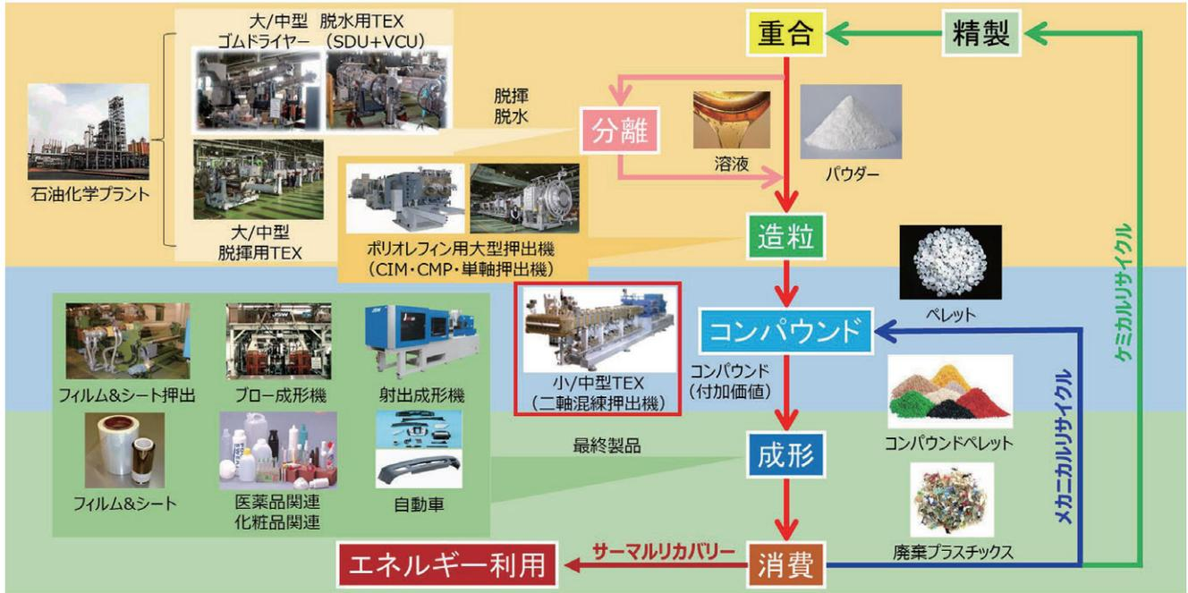
図1 ポリマー製造における二軸押出機の位置づけ
