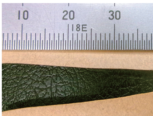
写真1 振動ありの切断面
