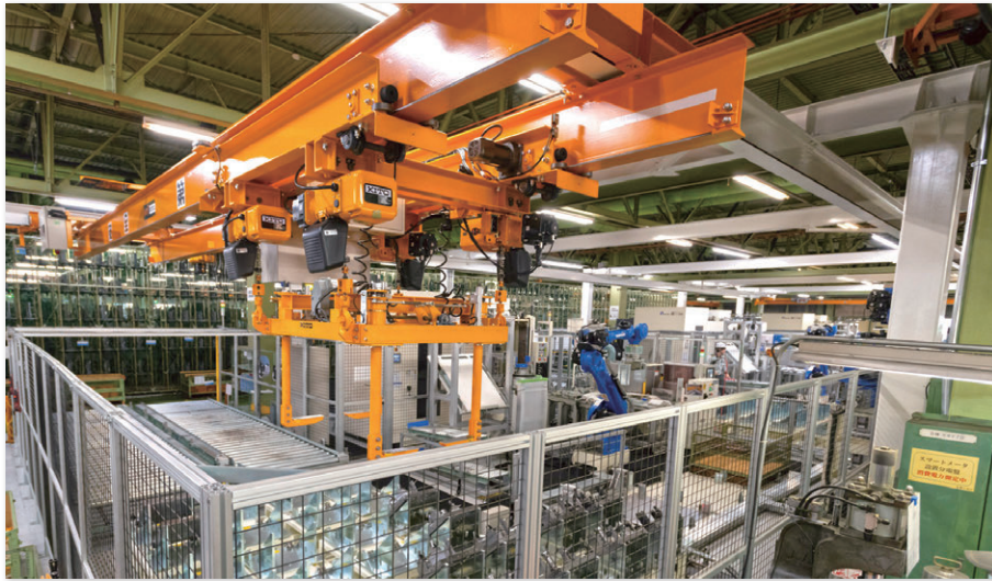
ロボットとキトーのオートクレーンが協働する自動化された部品加工ライン
