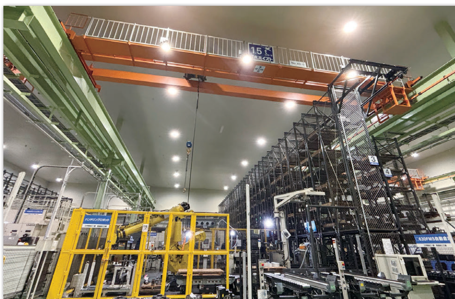
写真8 自動倉庫・AGV・ロボットによる切削加工のFMS
