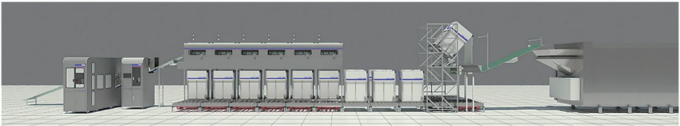
図1 システム1 連続洗濯機1台の例
