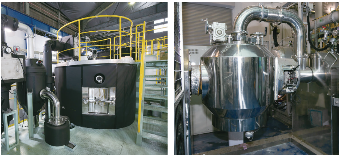
図6 噴霧凍結造粒装置 CS220とRHEOFREEDの外観とフロー図
