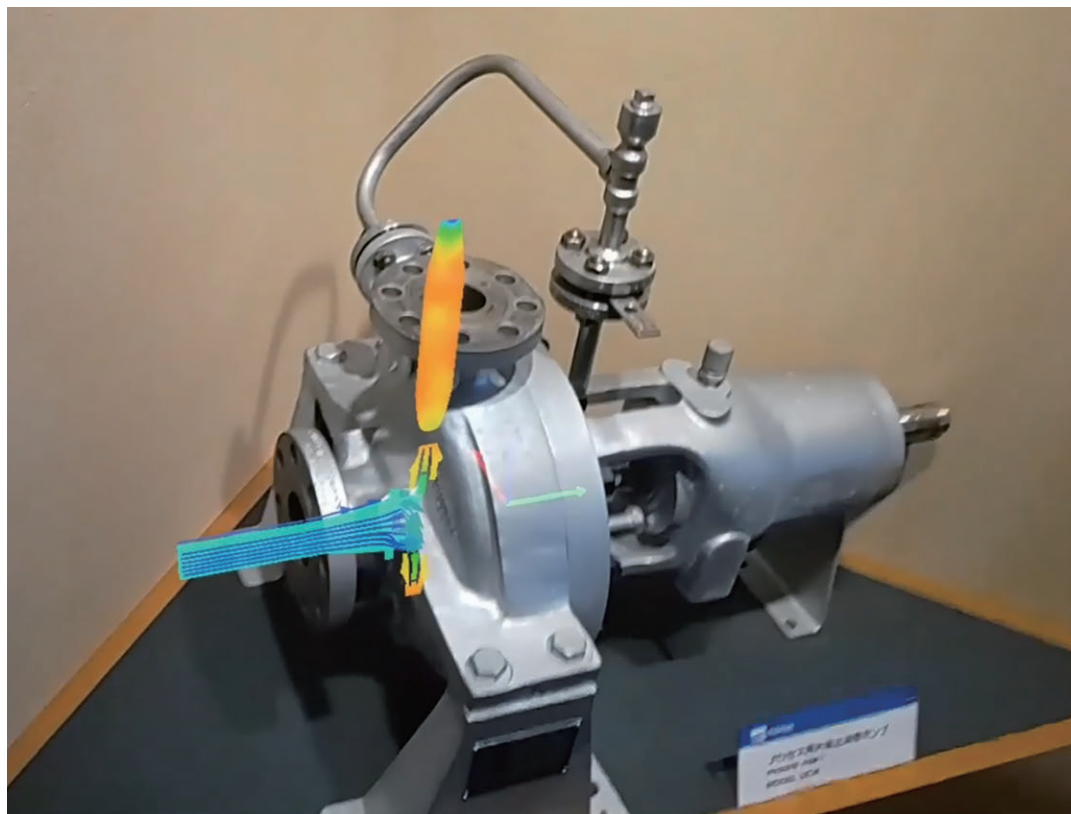
図4 MR可視化システムを利用した断面の可視化の様子。色付けは静圧を表す
