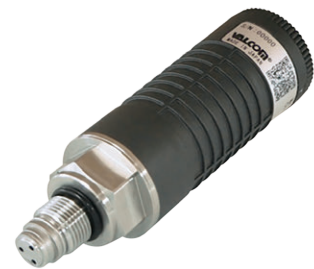
写真1 IoTマルチセンサ外観
