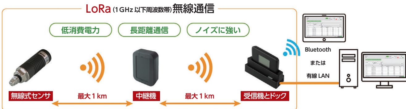
図1 IoTマルチセンサ システム構成
