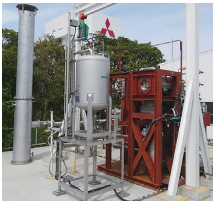
写真1 液体窒素でのポンプ耐久試験の状況
