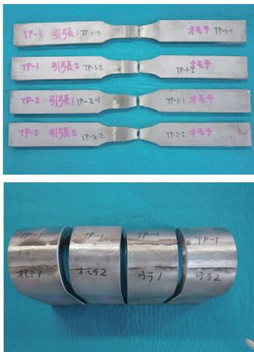
写真2 溶接施工法試験片
