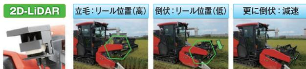
図4 作物の高さに応じた自動制御
