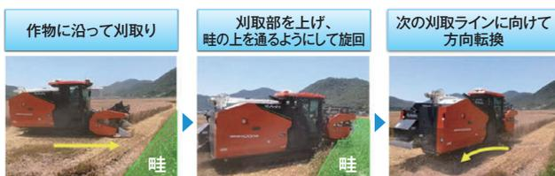
図5 畦の高さに応じた自動制御
