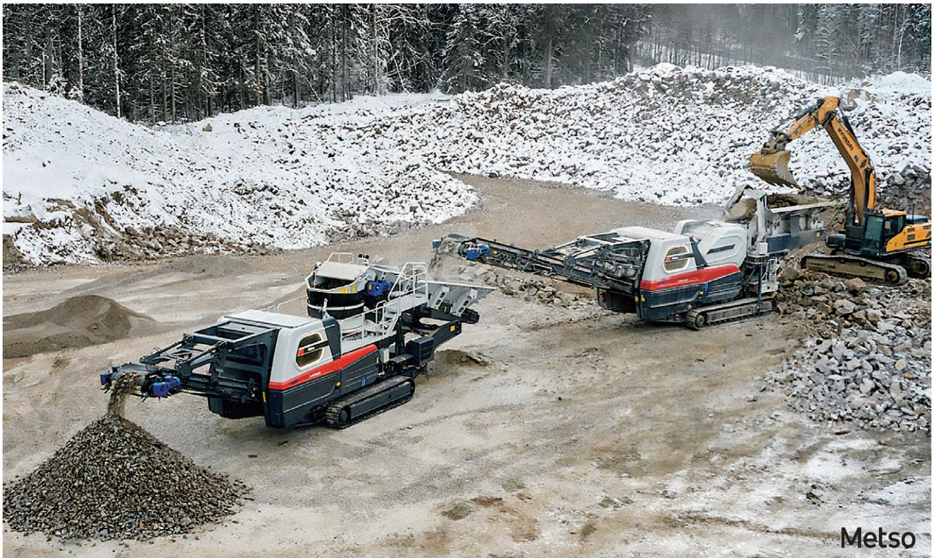
写真3 新型ロコトラックLT400J、LT350C 稼働風景
