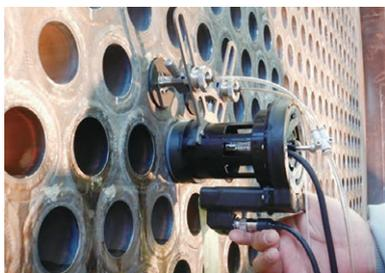
写真1 管端PAUT装置による探傷検査
