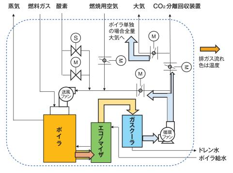
図1 CO2濃縮型小型貫流ボイラフロー
