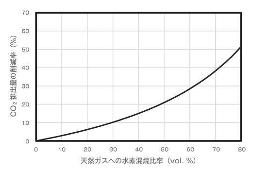
図3 天然ガスへの水素混焼比率に対する CO<sub>2</sub> 排出量の削減率
