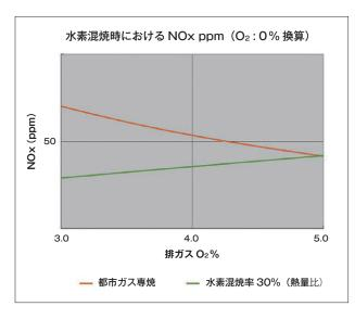
図3 水素混焼貫流ボイラ 評価機 K-750CSの燃焼性能 (環境条件は考慮せず)
