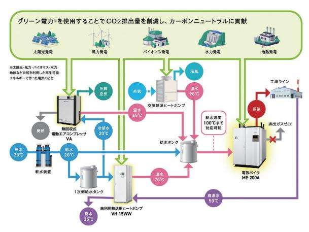
図2 電気ボイラと廃熱利用機器の組み合わせ例
