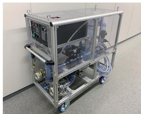
写真3 ボイラ水管肉厚測定ロボット
