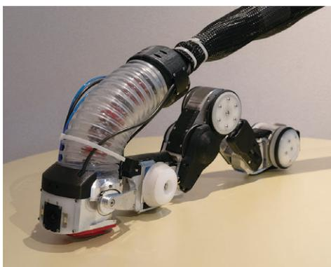
写真1 ボイラ水管肉厚測定ロボット
