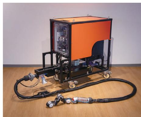
写真2 ボイラ水管肉厚測定ロボット
