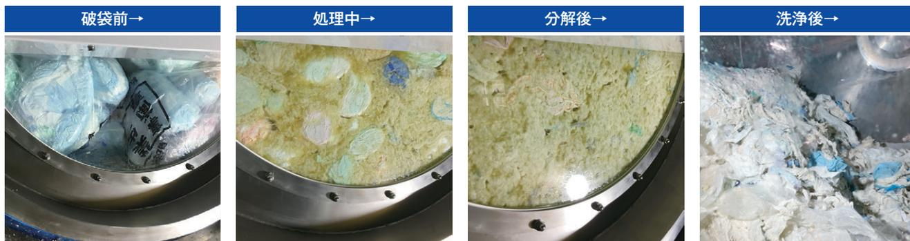
写真3 分別処理の様子(左から破袋前、処理中、分解後、洗浄後)
