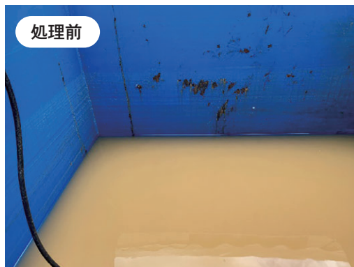
写真3 濁水(原水タンク)処理前
