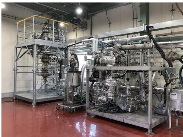
写真4 遠心薄膜蒸発器(左：立形、右：横形)
