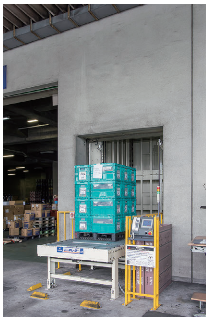
写真2 〈パレット〉バーチレーター
