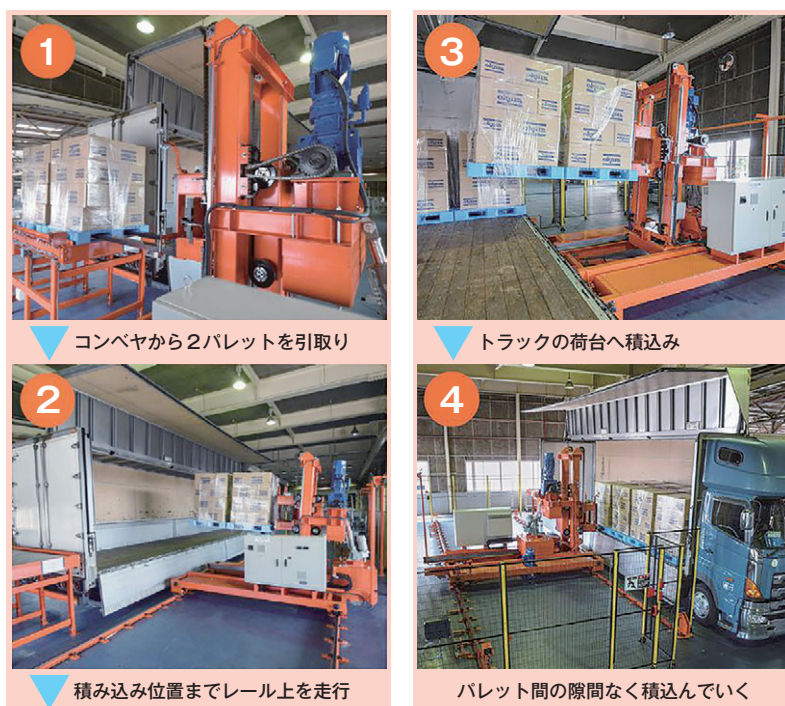
図2 コンパクト型トラックローダーの動作フロー
