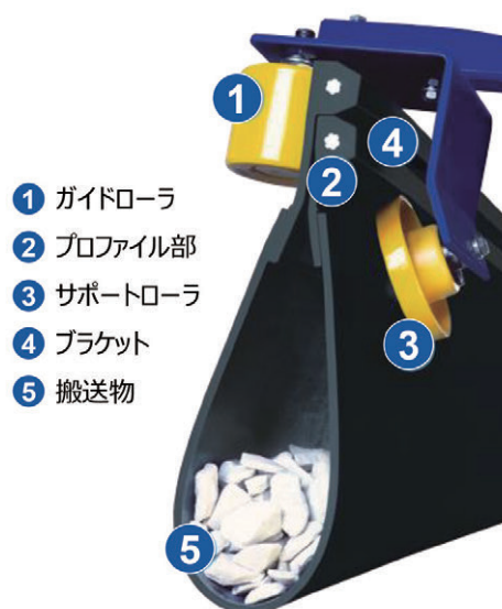
図1 SICON®基本構造
