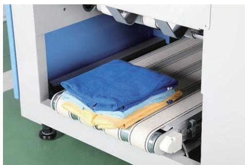
写真4 畳まれた衣類はT-BOXの下部で積み重ねられ(最大5枚重ね)機械外部に排出される
