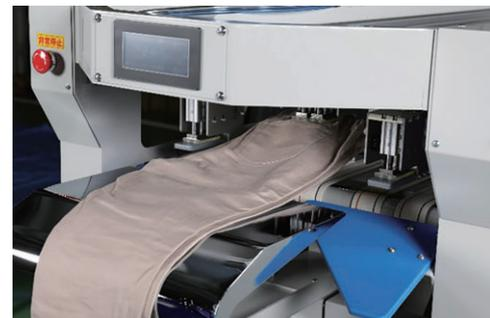
写真3 ズボンはT-BOXのズボン用クランプに2つ折りで腰部をセット
