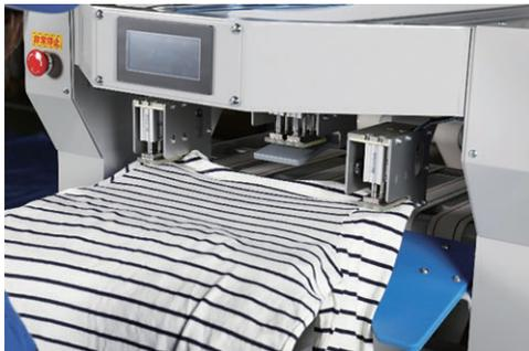
写真2 衣類はT-BOXのクランプに衣類の両肩部分を差し込む
