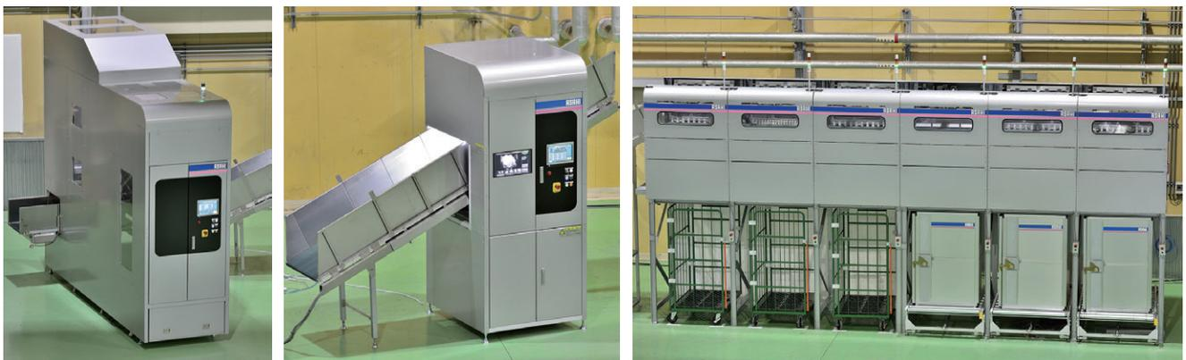
写真2 左からピッカー、識別装置、分別装置
