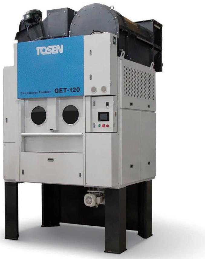
写真1 新型ガス乾燥機外観
