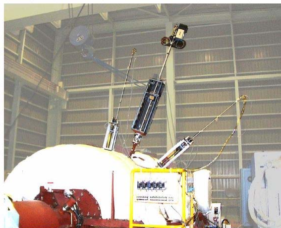
図 3.1.1-10 計測中の湿り度計測システム
