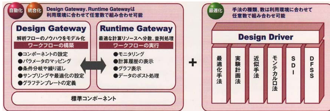
図 3.1.4-2 iSIGHT-FD の仕組み
