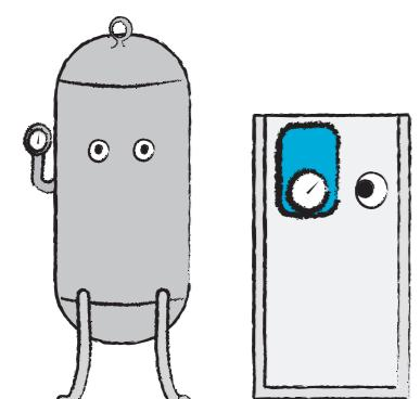
各機器の仕様に合わせて設置し、それぞれの機器が他の機器からの影響を受けないよう配慮するとともに、メンテナンススペースを十分に確保してください。
