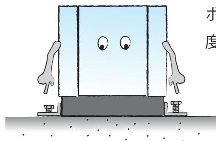
地震に対する備えとして、基礎コンクリートの上に設置して、基礎ボルトにて固定してください。なお、基礎コンクリートおよび基礎ボルトは、最新版の「建築設備耐震設計・施工指針」による必要強度を満たすように設置してください。
