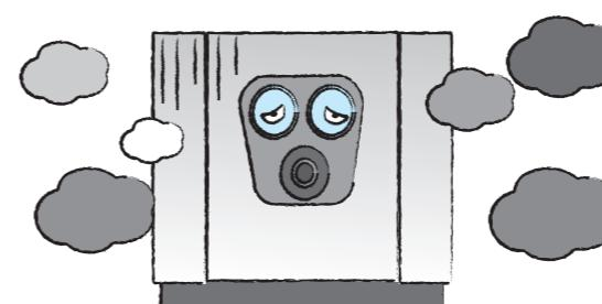
コンプレッサを複数台設置する場合やドライヤ等の高温の排気風がある機器と並列設置をおこなう場合、これらの高温の排気風をコンプレッサが吸引することができないように注意してください。コンプレッサの早期故障の原因となります。
