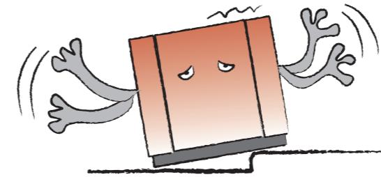
チャンネル架台上やブロック上にコンプレッサを浮かせて設置すると、設置方法によってはフレームにたわみが発生して機械が損傷する可能性があります。また傾斜した床では潤滑が不十分になったり、ドレンが逆流してコンプレッサが破損することがあります。コンプレッサの重量が均等に床にかかる水平面に設置してください。また、下部に隙間があると音が抜けで騒音が高くなることがありますので、隙間をモルタルなどで塞いでください。
