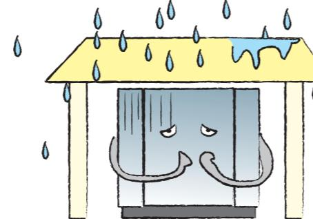
屋内仕様のコンプレッサを半屋外や屋外に設置した場合、雨水の浸入による早期発錆、電気部品のトラブル、コンプレッサ本体の劣化・損傷など、製品寿命が著しく低下します。屋外設置用のコンプレッサを選定ください。
