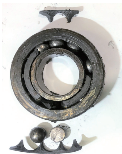
給脂不足により破損したベアリング
