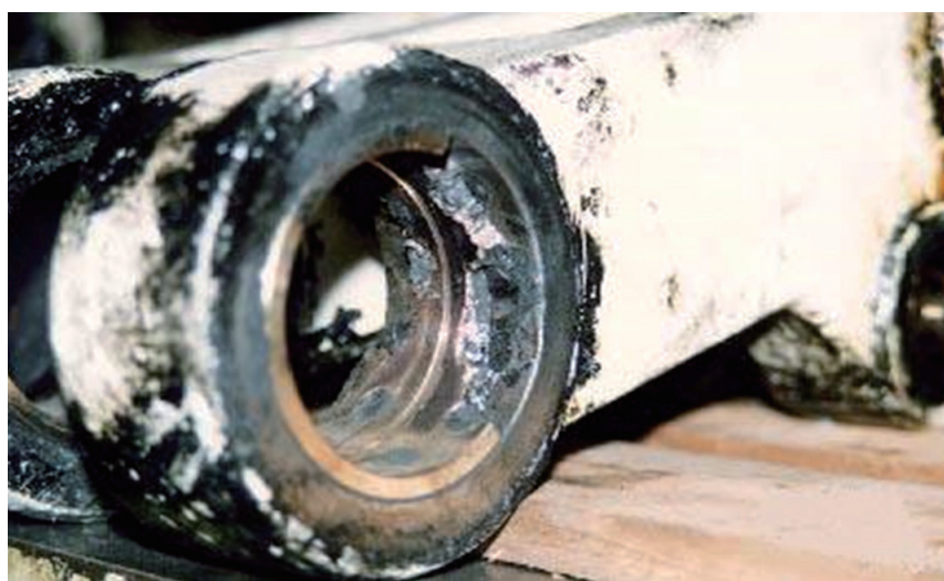
摩耗が進行した型締装置トルリンクブッシュ
