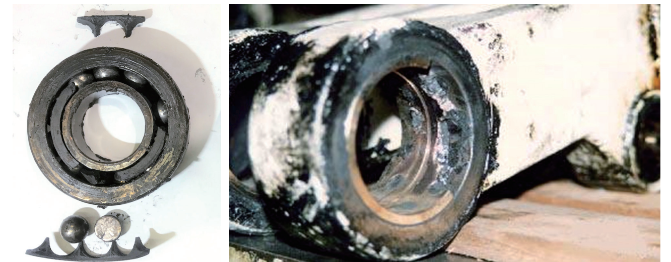
給脂不足により破損したベアリング
