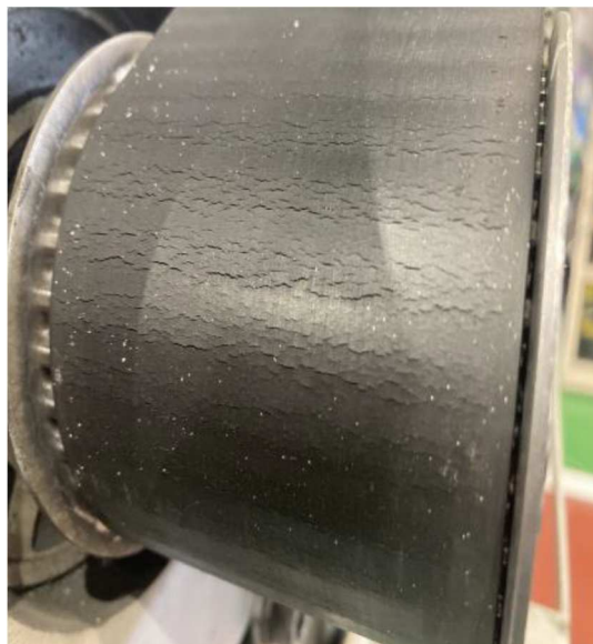
写真：摩耗が進行し、全体的に亀裂が入っている(悪い例)
