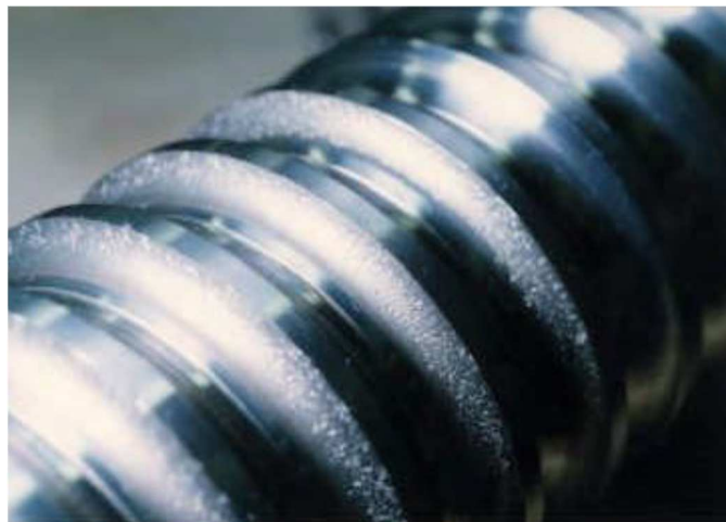
写真：剥離が進行している(悪い例)
