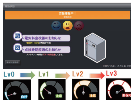
Fig.30 遠隔監視FitLive画面、吸込みフィルター目詰り表示
