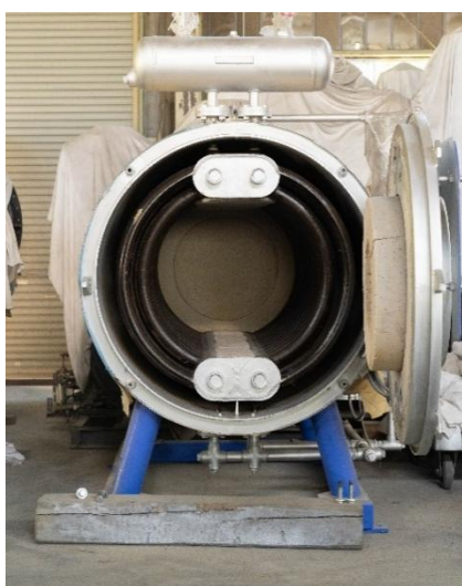
図表 3 本装置のボイラー内部
