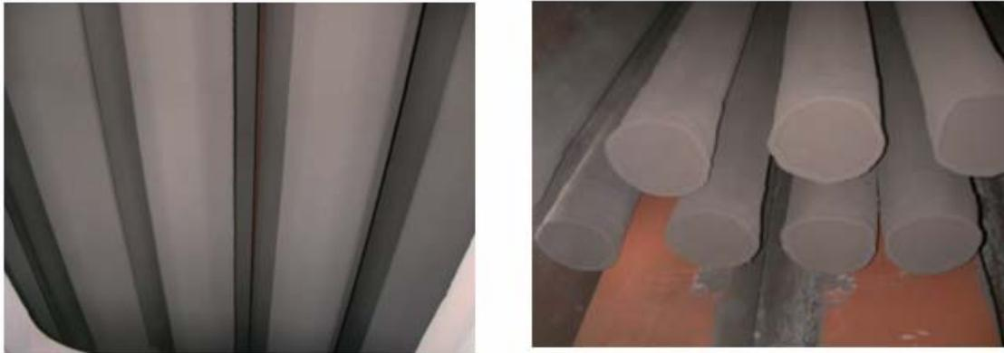
図5 集塵機内にて設置された長尺フィルタ (10m)
