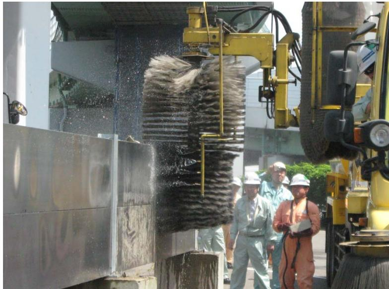
図10 洗浄試験実施状況
