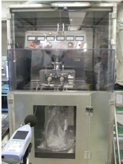
図13 防音パッケージへの適用例（1）
