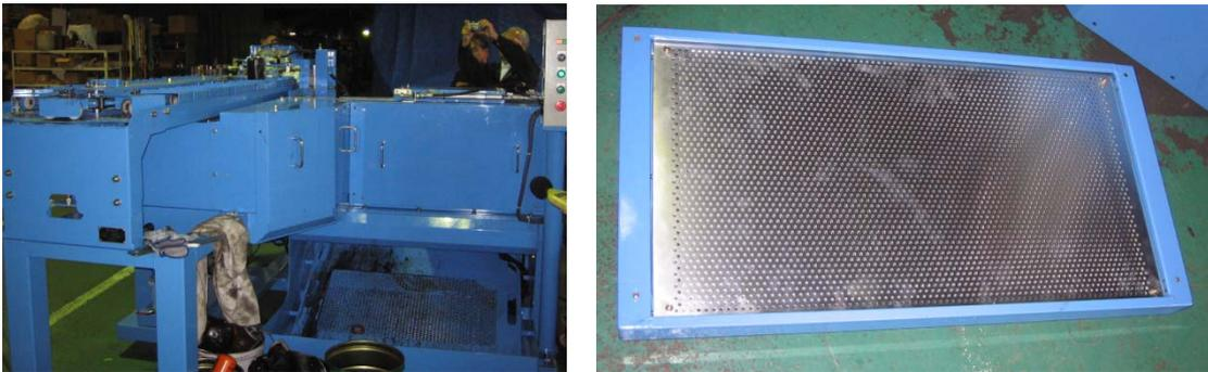
図14 防音パッケージへの適用例（2）（左、機械全景、右内部への取り付け状況）
