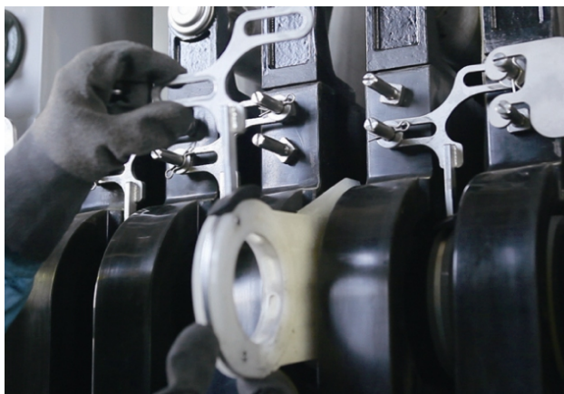
写真3 フィードピース取り外し状況
