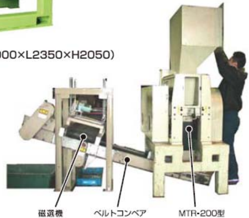
MTR-200型の設備事例(必要スペース:W2600×D1700×H2300)
