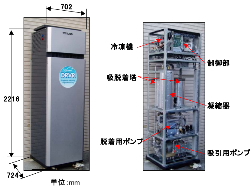
図 2-5 給油機用ガソリンベーパー回収装置 外観/内部構成
