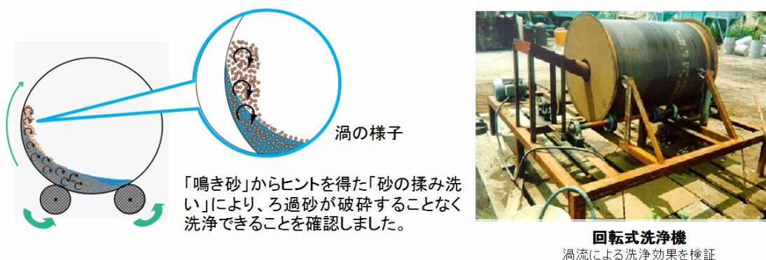
図 1-2 砂のもみ洗いに関する原理および検証機
