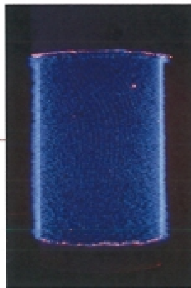
図 2-3. 完全予混合表面安定燃焼バーナの燃焼
