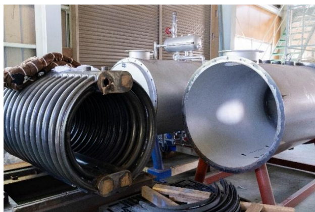
図表4 本装置のボイラー内水管
