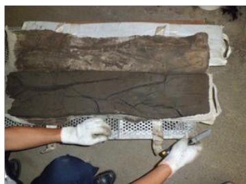
脱水ケーキ開封状況
