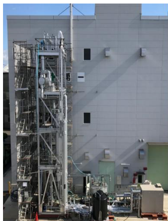
図表 3 当社が開発したヒートポンプ式メタノール蒸留装置
