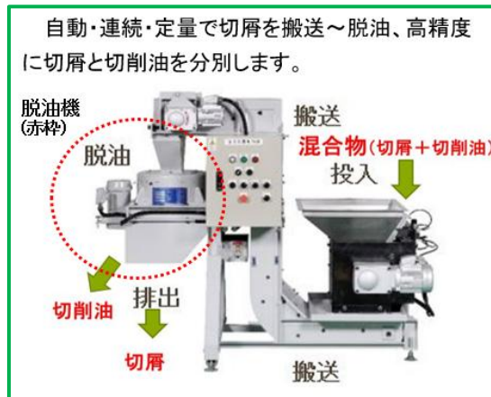
図表1 本システム外観構造
