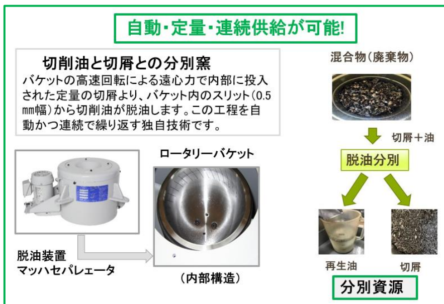
図表2 本システムにおける脱油機構
