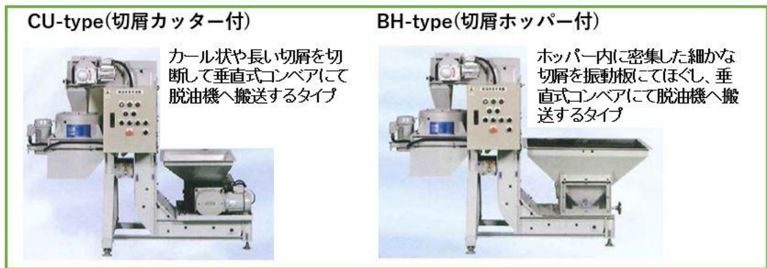
図表6 本システム（標準仕様）の切屑用途別タイプ
