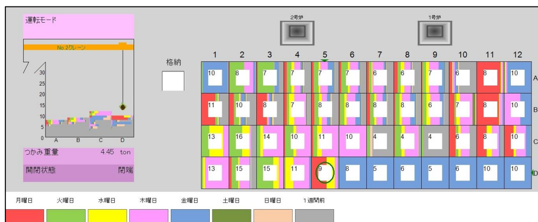
図表 5-2 ごみピット 3D システムの表示画面（搬入日別含有率表示）
