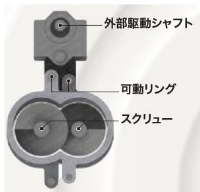
図表1 シリンダーユニット断面図
