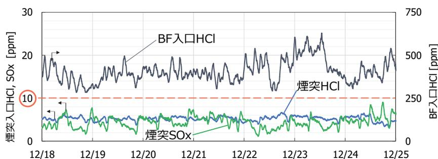
図2 本システム運転時のHClとSO<sub>x</sub>の1時間平均値の挙動
