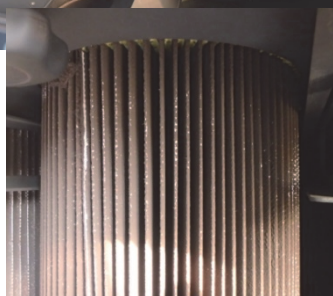
新方式フィルタ外観 8,500 時間運転後・通常運転直後
