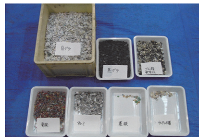
ミックスプラスチック品手選別後の原料構成写真
